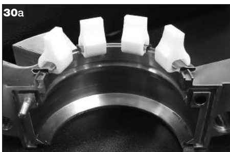
Fjederløfterclips installeret i stopbøsningshalvdele.
