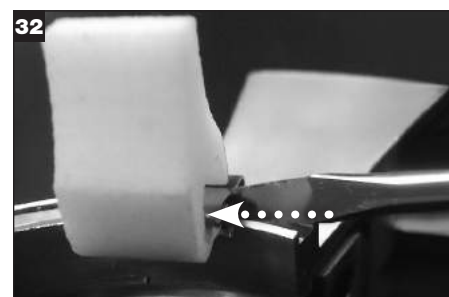
Indstil fjederløfterens stilling ved brug af en skruetrækker med lige kær. Vigtigt: Fjederløfterens ende skal være på linje med endefjederens kant. Fjern alle clipsene og gem dem til en anden gang, når løfterstillingen skal genindstilles.
