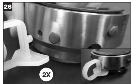
Installer installationsafstandsstykker på den udvendige diameter af holderhalvdelene.
