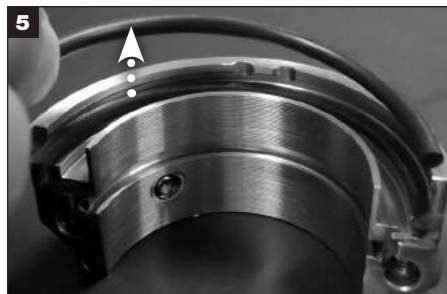
5 Fjern den roterende flades brugte O-ringhalvdele.
