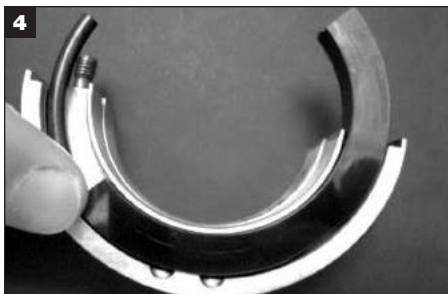
4 Fjern de brugte halvdele af den roterende flade ved at skubbe på enden af fladen og lade den glide ud af rotationsholderhalvdelen.
